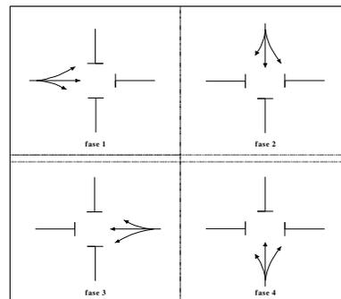
Gambar 3 Gambar suatu perempatan dengan 4 fase
