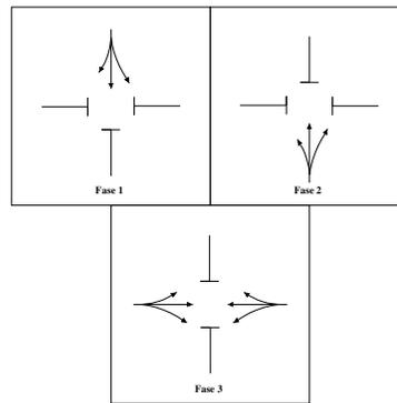
Gambar 2 Gambar suatu perempatan dengan 3 fase
